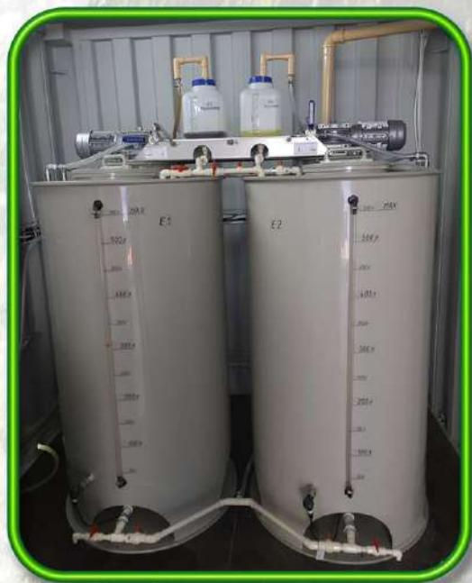
Для приготовления мыла в одну из ёмкостей через проточный водонагреватель из внешнего источника, закачивается питьевая вода.
