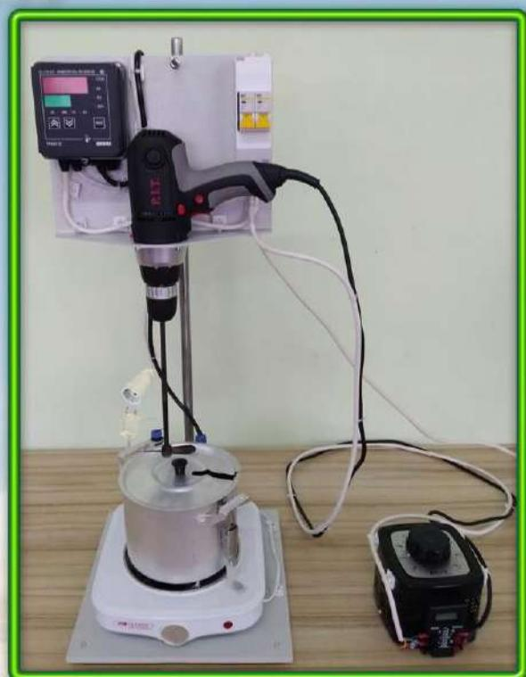
**Ёмкость, в которой при заданной температуре происходит растворение полимеров, пластификаторов и других добавок имеет лёгкосъёмное крепление для удобства приготовления навесок используемых материалов.**
