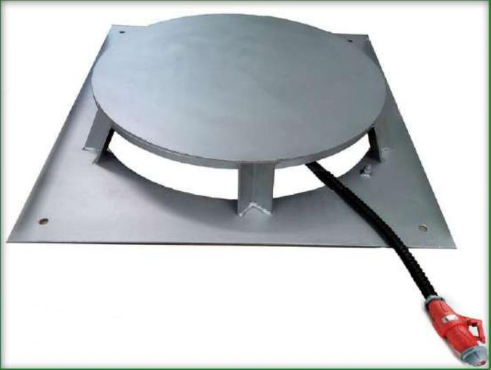
НБ-6 состоит из основания и нагревательной поверхности, на которой снизу закреплены 3 нагревательных элемента мощностью 2,0 кВт каждый. Нагревательные элементы соединены между собой термостойкими проводами по схеме «звезда».
